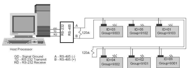
Figure 4.13—HPB RS-485 Multidrop Network
