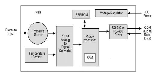
Figure 4.1—HPB Block Diagram
