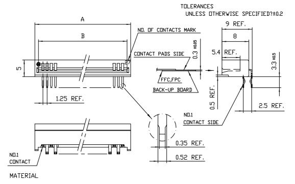
INSULATOR : PBT RESIN GLASS REINFORCED (UL94V-0) COLOR : BLACK
