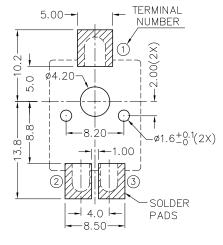
RECOMMENDED SOLDER PAD LAYOUT (TOP VIEW)
