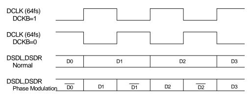
Figure 11. DSD Mode Timing
