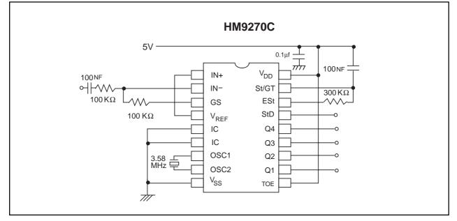
FIGURE 2. SINGLE ENDED INPUT CONFIGURATION
