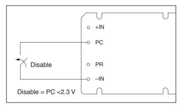
Figure 2 — Module enable/disable.
