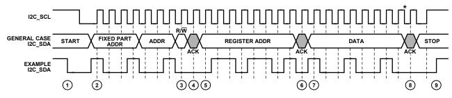
\*THE SWITCHING/UPDATE DELAY BEGINS AT THE FALLING EDGE OF THE LAST DATA BIT; FOR EXAMPLE, THE FALLING EDGE JUST BEFORE STEP 8.
